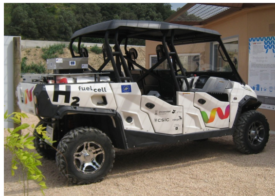
Fig. 3. Vehículo híbrido de pila de combustible-baterías. La instalación del sistema de hidrógeno se muestra en la parte trasera.
