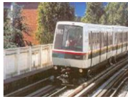
VAL 206 (Véhicule Automatique Léger) in Lille in 1983 with DC motors
