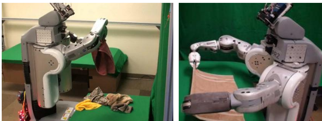
Figura 1.1: El robot PR2 de la Universidad de Berkley puede doblar toallas de diferentes tamaños y colores partiendo de una posición inicial desconocida.
