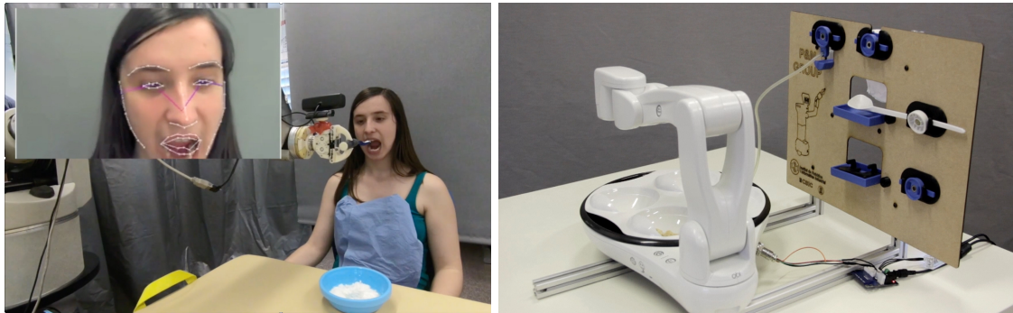
Fig. 3 – (a) Prototipo de robot para dar de comer. (b) Miniaturización y cambio de utensilios.
